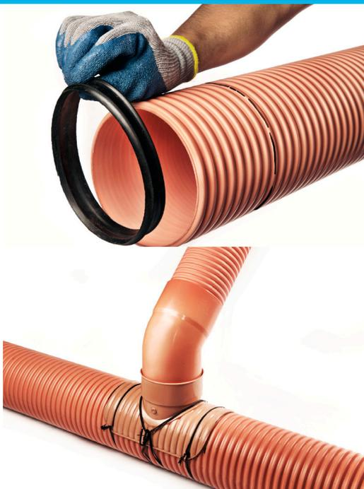
El empalme entre el codo y la tubería de la conexión domiciliaria irá sellado empleando anillo de caucho; mientras entre la silla tee y la espiga del codo se empleará pegamento para PVC.
